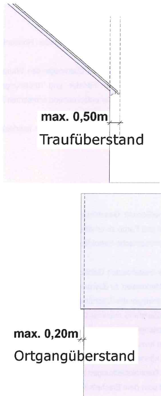
Prinzipskizze Trauf- und Ortgangüberstand
